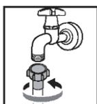
1. Подсоедините шланг подачи воды к водопроводному крану, а затем поверните гайку по часовой стрелке, как показано на рисунке.
